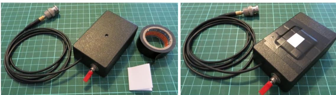
由於 TSL257 的高光感度，入射到感測器的光需要被衰減相當多，才能適合於直接量測 LED 燈串的光。將數層 A4 紙張放置在該孔以產生足夠的光衰減。本測試裝置，共使用了 8 層的紙。
