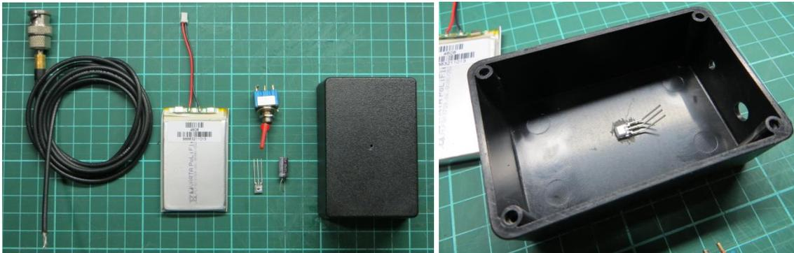
所需的零組件：同軸電纜線，鋰離子電池，TSL257 IC，一個開關，22 $\mu$ F 25V 電解電容，和黑色塑膠盒，並在它的頂部鑽一 3mm 的孔。將 TSL257 和感測器放置一起並朝向該孔。
