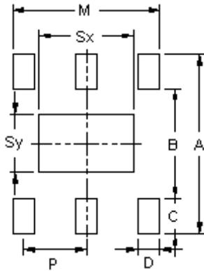
**V/W/X DFN-2x2-8L / V/W/X DFN-3x3-8L**
