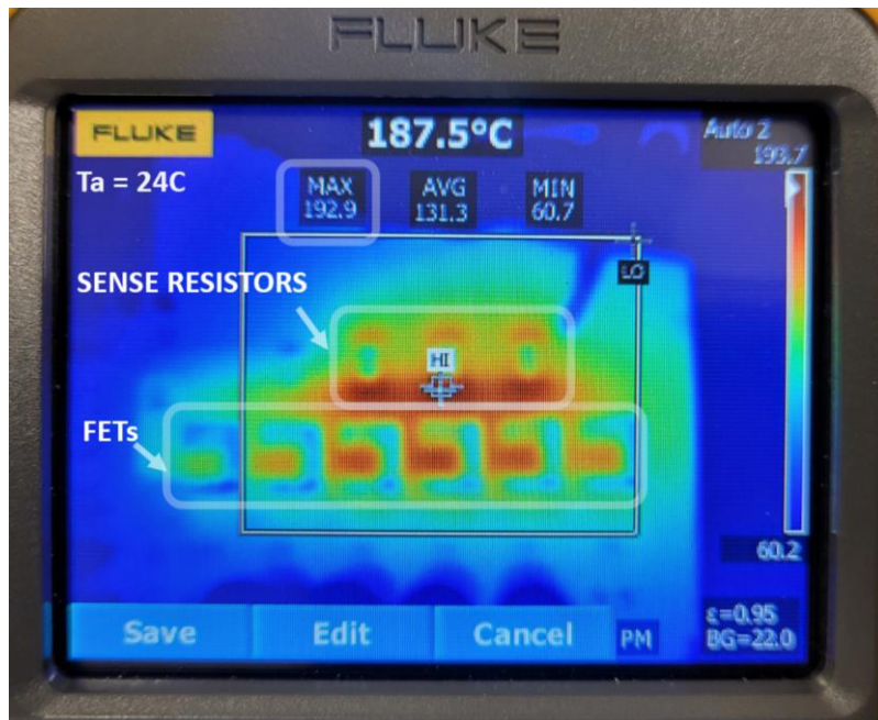
圖 14. Soft Short 情況示意，以及其他僅具單一過電流保護等級 ( I_{LIM}=300A ) 熱插拔控制器可能發生的故障風險。當電流達 285A 且持續 4 分鐘後，MOSFET 外殼溫度上升至 180°C。
