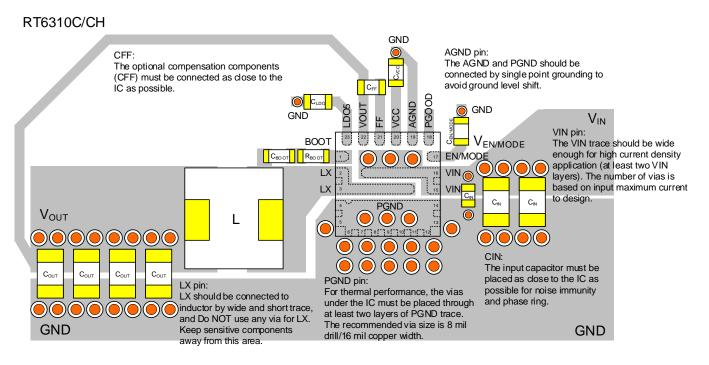
Figure 23. RT6310C/CH Layout Guide
