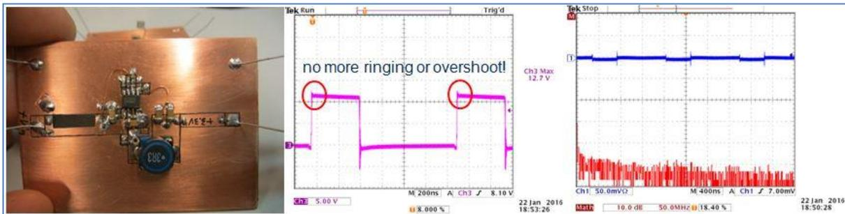
图 25：使用最短化 C<sub>IN</sub> 回路的最后方案
