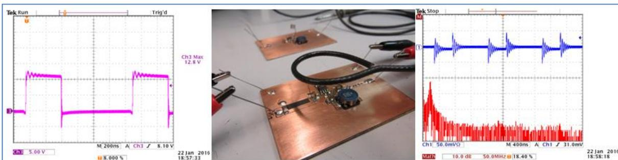
图 23：在 IC 的 GND 和 VIN 之间增加一只 0603 10nF 电容
