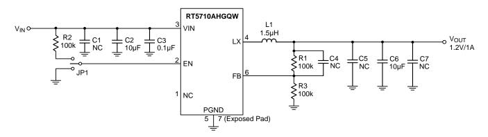
C2, C6 :  $10\mu F/25V/1206$  X7R GRM31CR71E106KA12L L1 :  $1.5\mu H, 31m\Omega, I_{SAT} = 4.3A, Wurth 74404042015$
